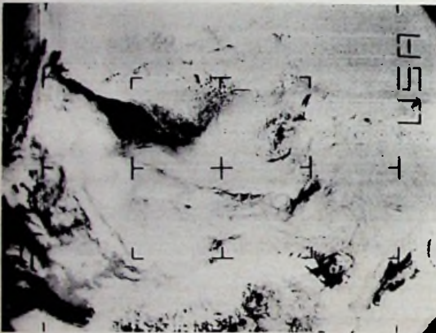
Afb. 31. Oversturing bij de bandopname en/of beeldomzetting wreekt zich met name bij de witte beeldpartijen. Dit kan door zorgvuldige instelling en afregeling worden voorkomen. Bovenstaande opname laat zien dat details in het wit niet verloren behoeven te gaan. De opname werd gemaakt op 12 mei 1971 van de NOAA-1 en vertoont uitgebreide wolken en ijsvelden. De westkust van Noorwegen ligt nagenoeg horizontaal op \frac{1}{4} van de onderzijde. Projecteert men in gedachten de wijzers van een uurwerk op het beeld, dan vindt men op circa 5 voor half 6 de kop van Noorwegen, ten dele onbewolkt. Met behulp van de atlas is de Toelama, waaraan Moermansk ligt, op de afbeelding duidelijk waarneembaar; meer naar rechts de westkust van Nova-Zembla. Het gebied in de rechter bovenhoek van de opname ligt in de onmiddellijke nabijheid van de Noordpool. De breedte van de opname komt overeen met een afstand van ca. 3200 km. De NOAA-1 is een tijd buiten werking geweest. In april werd hij weer actief, korte tijd later door de ITOS-1 gevolgd. De NOAA-1 opname vertoont de letters U.S.A. naast elkaar. Een week later vertoonden de beelden weer onder elkaar staande letters U.S.A., zoals vroeger het geval was. Een en ander hangt wellicht samen met het feit, dat een aantal instrumenten in het ruimteschip in duplo zijn uitgevoerd, ook de APT-camera's, die vanaf de grond op commando kunnen worden in- of uitgeschakeld.
